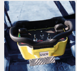
Optionale Möglichkeit zur Steuerung über Fernsteuerung
