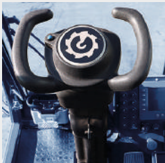
Ergonomische Lenkung mit Lenkrad und Gaspedal
