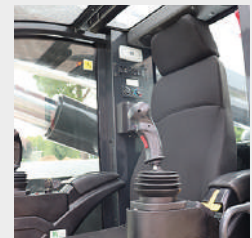
Komfortable Kabine mit Heizung, Klimaanlage, gefedertem Sitz
