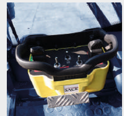
Optionale Möglichkeit zur Steuerung über Fernsteuerung
