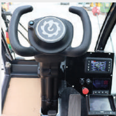
Ergonomische Lenkung mit Lenkrad und Gaspedal
