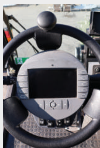
Volant réglable en hauteur et en inclinaison
