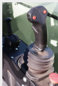
Joystick pour les fonctions de commande
