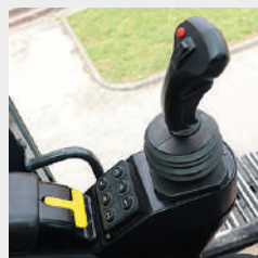
Linker Joystick zur Steuerung von operativen Funktionen
