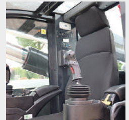
Cabina confortevole dotata di riscaldamento, aria condizionata, sedile con sospensioni pneumatiche
