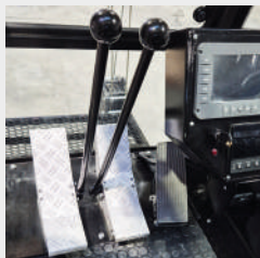
Ergonomische Steuerung mit elektronischen Fahrpedalen
