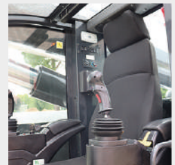
Komfortable Kabine mit Heizung, Klimaanlage, gefedertem Sitz
