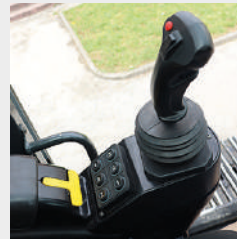
Joystick izquierdo de control para funciones operativas
