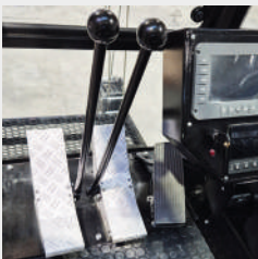
Guida ergonomica con pedipolatori elettronici
