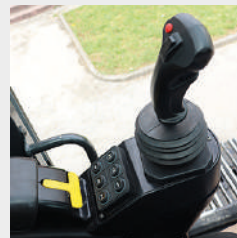
Joystick sinistro di comando per funzioni operative
