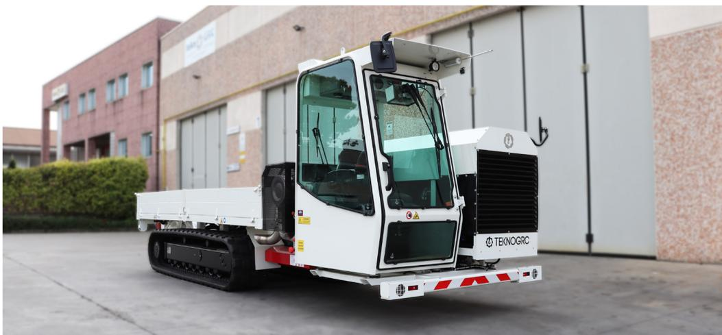
La macchina è equipaggiata di sottocarro cingolato Gemmo Group e di motore Cummins B4.5 Stage V - Tier 4F 149 kW - 780Nm.
