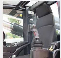
Cabina cómoda equipada con calefacción, aire acondicionado y asiento con suspensión neumática
