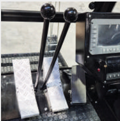
Conducción ergonómica con pedales electrónicos
